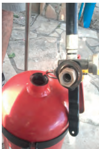
Εικόνα 2.1 Το κλείστρο του πυροσβεστήρα που αστόχησε.
