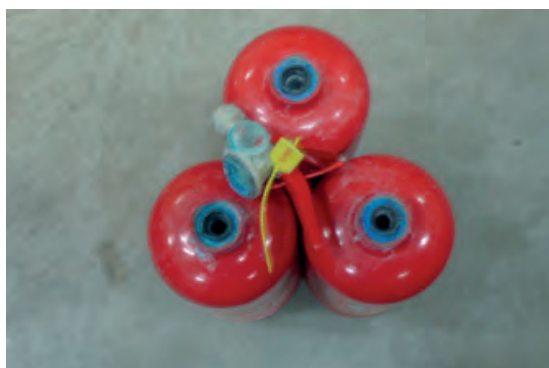
Εικόνα 2.1 Το κλείστρο του πυροσβεστήρα που αστόχησε.
