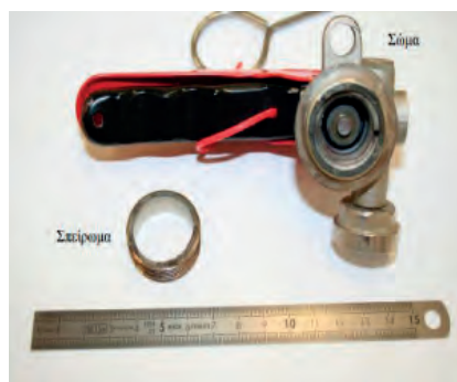
Εικόνα 2.1 Το κλείστρο του πυροσβεστήρα που αστόχησε.
